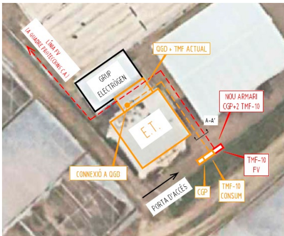
Detall traçat del cablejat CA de l'escomesa consum i generació FV
